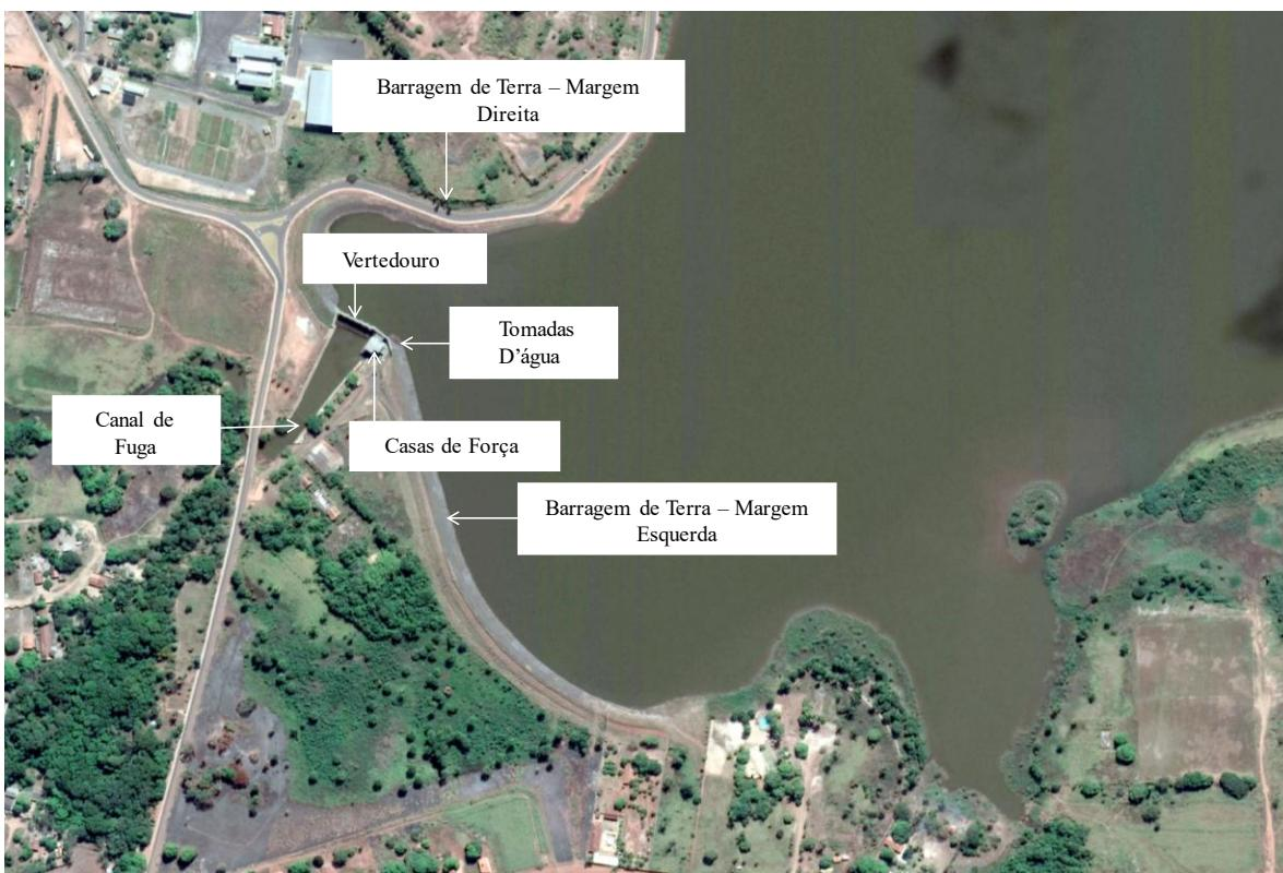
**Figura 3 - Arranjo Físico da PCH Corujão**
