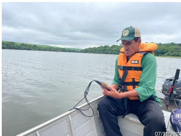
Figura 27. Aferição de parâmetros abióticos da água com o auxílio de sonda multi-parâmetros, novembro de 2024.
