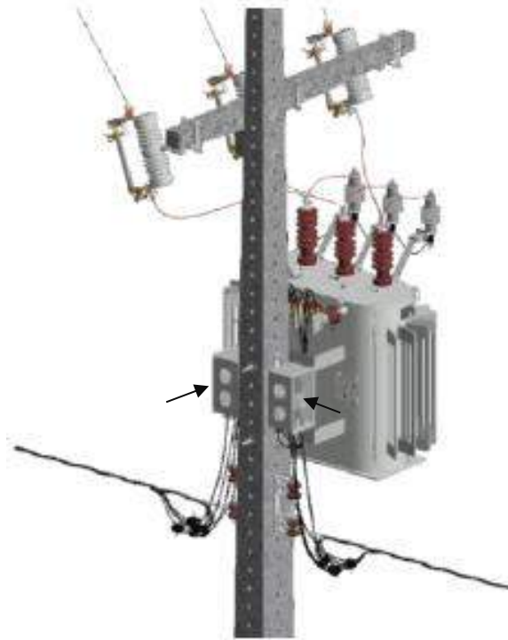
Figura 24 - Painel de distribuição de BT em poste (a)
