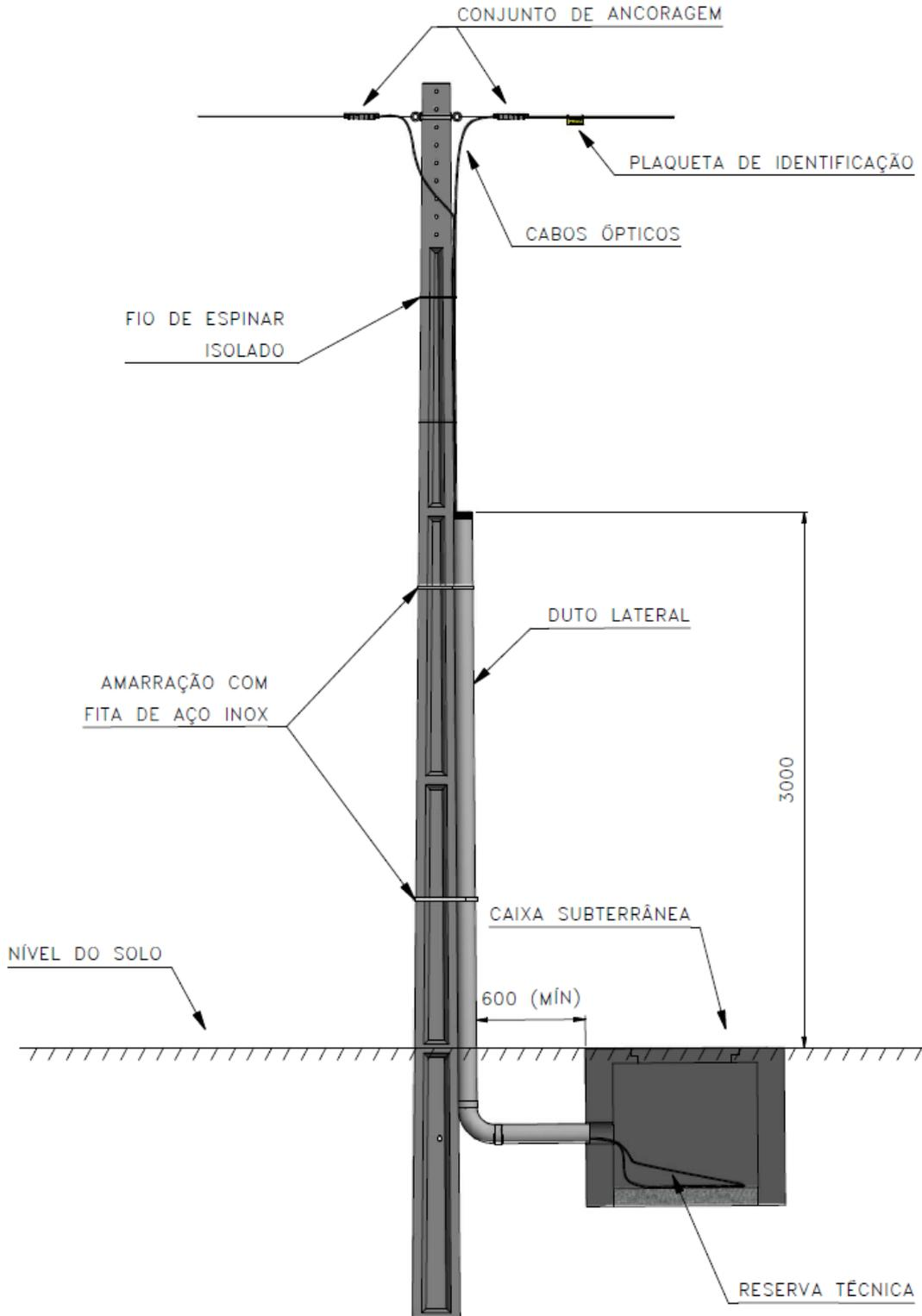
**NOTA: 1** - Os dutos de descida dos cabos de telecomunicação devem ser de aço galvanizado.
