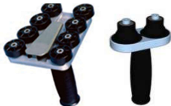
Figura 12 - Desenho Ilustrativo: Ferramentas auxiliares de instalação de proteções Isolantes
