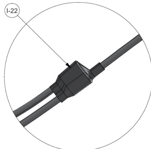
DETALHE 2 APLICAÇÃO DA FITA ISOLANTE NO CONECTOR
