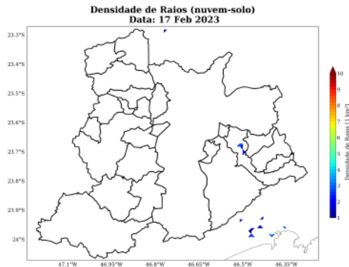
Figura 17: Densidade de descargas atmosféricas nuvem-solo detectadas pelo sistema Earth Networks para o dia 17 de fevereiro sobre a área de concessão da Enel-SP.
