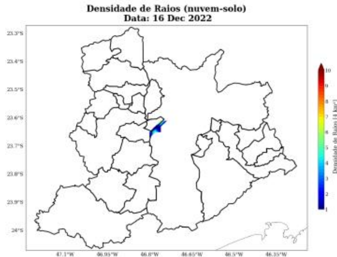
Figura 16: Densidade de descargas atmosféricas nuvem-solo detectadas pelo sistema Earth Networks para o dia 16 de dezembro sobre a área de concessão da Enel-SP.
