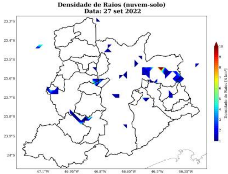
Figura 16: Densidade de descargas atmosféricas nuvem-solo detectadas pelo sistema Earth Networks para o dia 27 de setembro sobre a área de concessão da Enel-SP.
