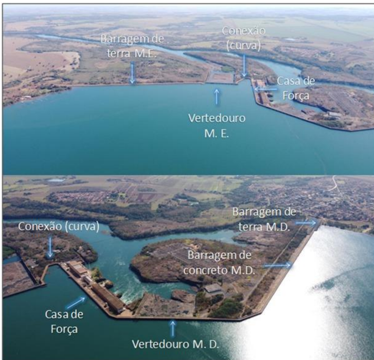
Figura 2 – Arranjo geral da UHE Cachoeira Dourada
