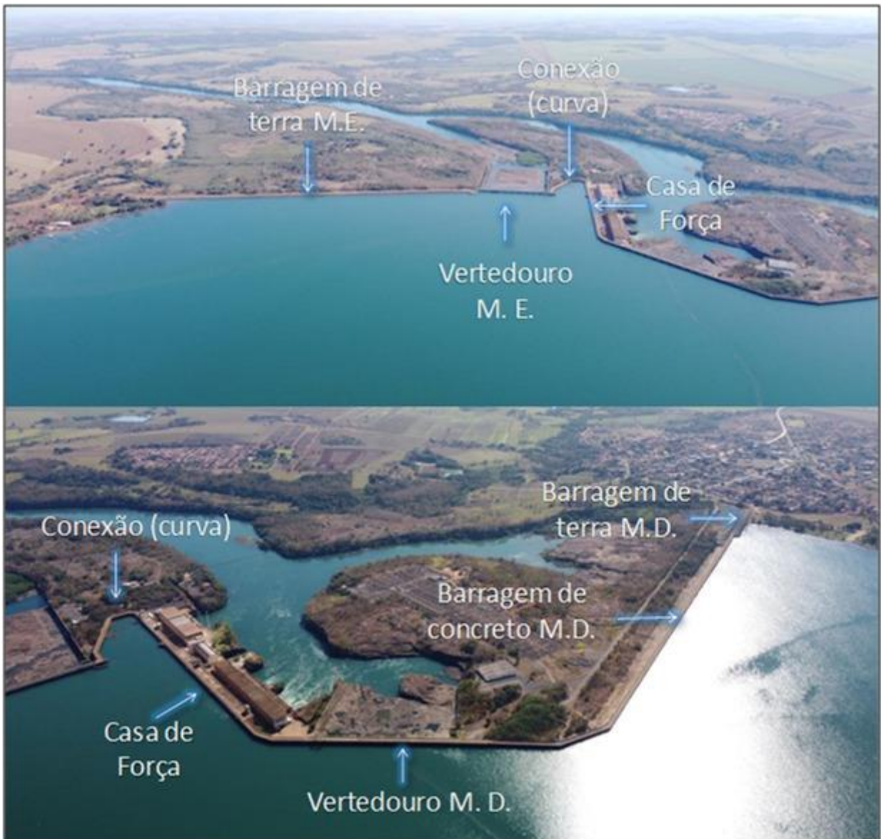
Figura 2 – Arranjo geral da UHE Cachoeira Dourada
