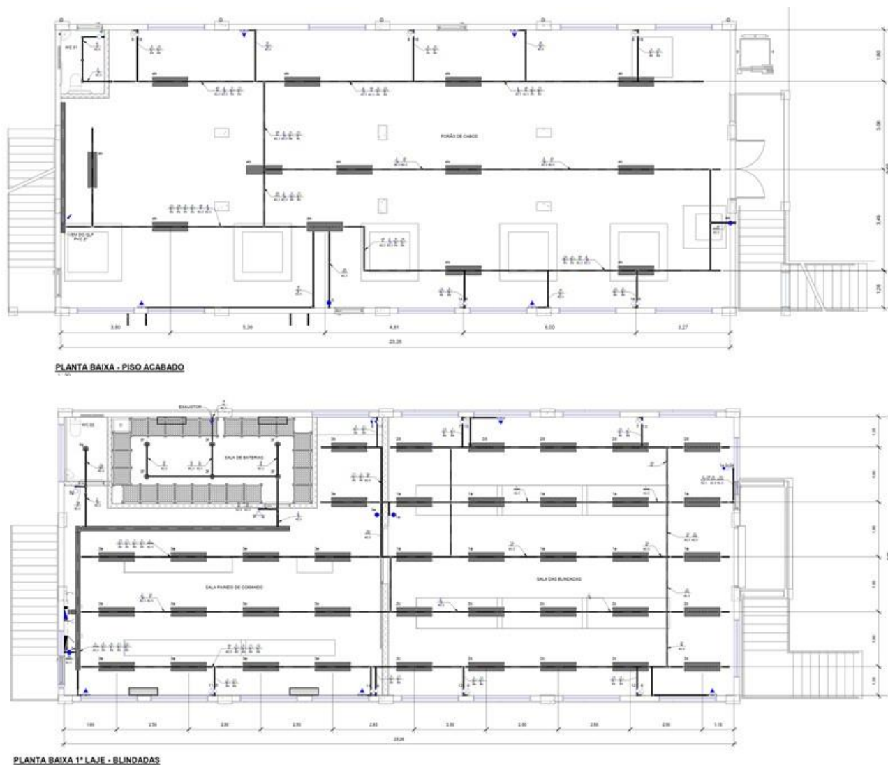
Figura 7 - Modelo de instalação elétrica
