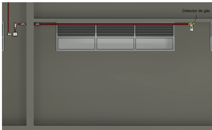
Figura 15 – Esquemático ilustrativo Detalhe típico Sistema de Detecção por Gás Sala de Bateria.
